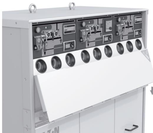
Рис. 3-14. Снятие передней панели
