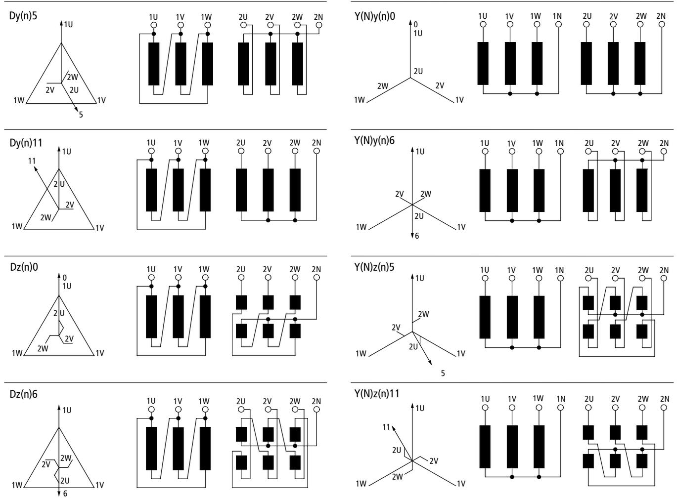
Нейтраль обозначается добавлением к типу схемы «n» для вторичного напряжения («N» – для первичного).
